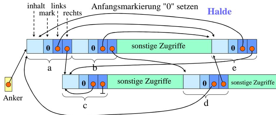
Ziel muss es nun sein, die Knoten b und d als löschbare Knoten zu erkennen. Hierzu durchläuft man ausgehend von "Anker" alle Zeiger und markiert die erreichten Knoten mit true (oder einer "1"). Dies geschieht für alle "Anker", die aus den lokalen Speichern in die Halde verweisen. Danach löscht man alle mit false (oder "0") markierten Objekte und schiebt ggf. den Speicher zusammen.
