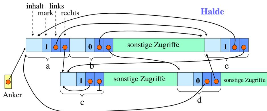
Ergebnis des Durchlaufs: Ausgehend von "Anker" wurden alle Zeiger nachverfolgt und die hierbei erreichten Knoten mit einer "1" markiert; die nicht erreichbaren bleiben mit "0" markiert. Anschließend kann man den Speicherbereich neu organisieren, sofern man möglichst große Freispeicherbereiche benötigt.
