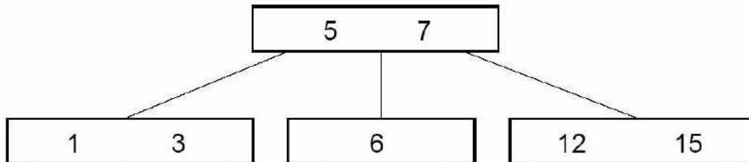
Fügen Sie den Schlüssel 14 ein, und strukturieren Sie den Baum ggf. um. Zeichnen und erklären Sie die einzelnen Schritte des Einfügens.
