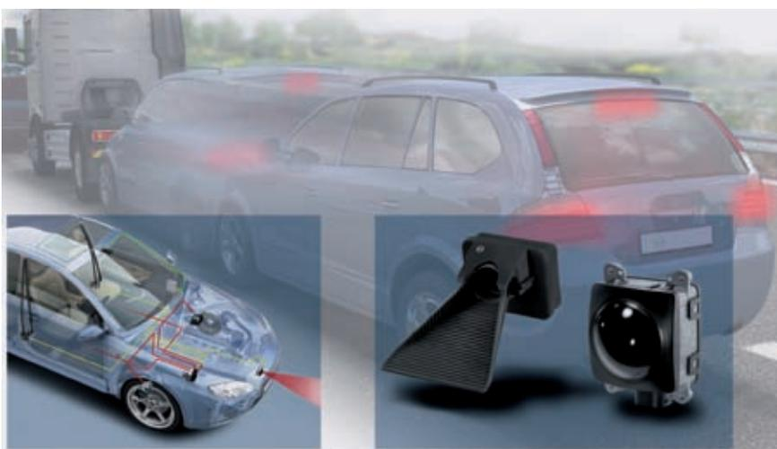
**Bild 1:** Teilbereich einer Fallstudie: ein Notfallbremsassistent (EBA)
