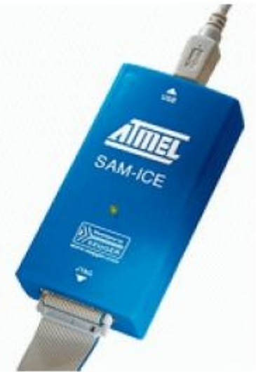
Abbildung 2-3: Atmel SAM-ICE Emulator für AT91 Mikrocontrollern[GNU07]
