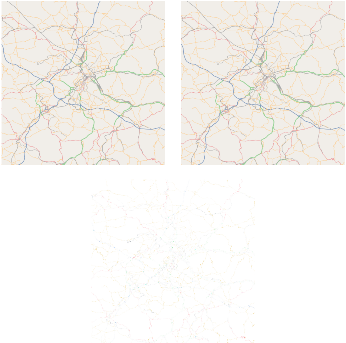
Abbildung 6.3: Vergleich der Ergebnisse bei Vereinfachung der PolyLines; oben links: ohne Vereinfachung; oben rechts: mit Vereinfachung; unten: Differenzbild (invertiert und leicht erhöhter Kontrast)
