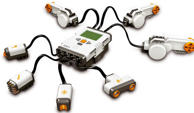
Abbildung 3.1.: NXT-Baustein mit Sensoren und Aktoren.
