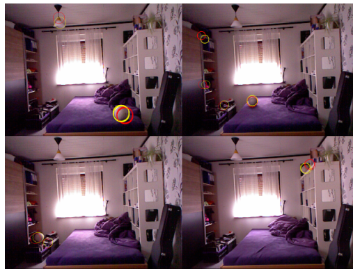
Abbildung 13: Transformation von vier zufällig ausgewählte Ballposition mit dem Verfahren aus Kapitel 4.2 vom Tiefenbild ins Farbbild
