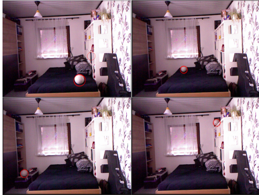
Abbildung 14: Transformation von vier Ballpositionen mit der voreingestellten Kalibrierung des Kinect Sensors
