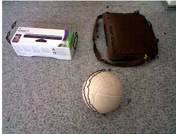
Abbildung 6: Farbbild mit überlagerten Kanten aus dem Tiefenbild
