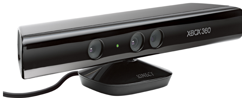
Abbildung 4.1: Microsoft Kinect. Die Kinect verfügt über einen Sensor zur Distanzmessung, eine RGB-Kamera, Mikrofone sowie einen Motor, der ihren Sensorblock drehen kann. Quelle: www.microsoft.com
