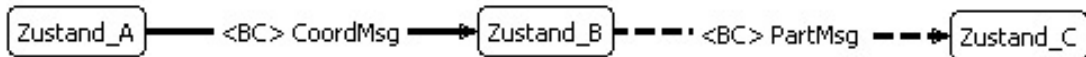
Abb. 2-11: Paralleles Versenden von Nachrichten in CTC-Graphen (Broadcast-Nachrichten an alle Participants) 14 und die dazugehörige Antwort-Nachricht der Participants
