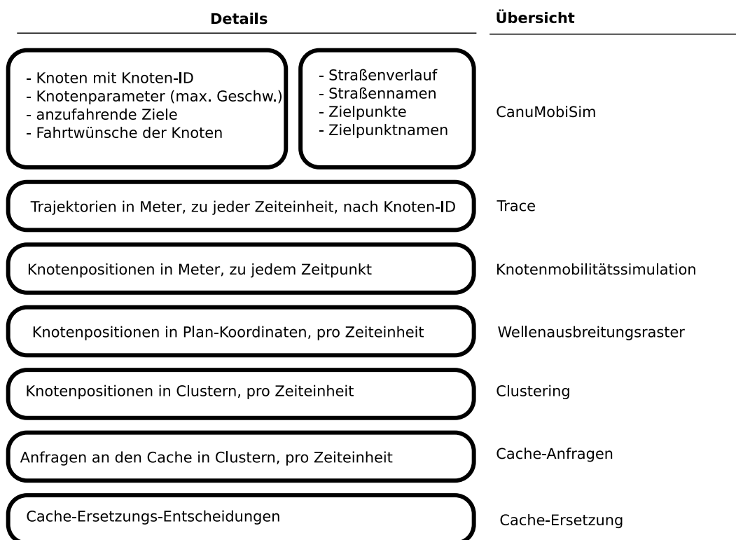
Abbildung 6.1: Schichtenprinzip der Simulation
