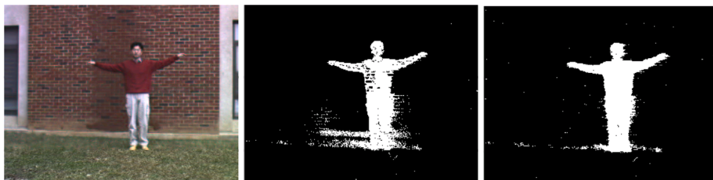
Abbildung 6.5: In dieser Abbildung ist zu sehen, wie Tarnung die Leistung der Verfahren beeinträchtigen kann. In der mittleren Abbildung ist ein Subtraktionsbild zu sehen, dass viele Vordergrundpixel nicht richtig klassifiziert.
