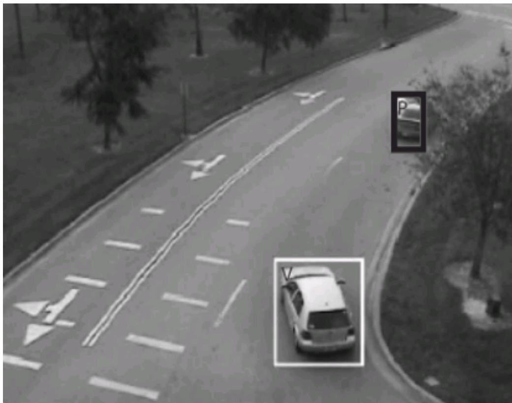
Abbildung 6.6: In dieser Abbildung ist zu sehen, wie Klassifikationsaufgaben fehlerhaft durchgeführt werden, wenn sie bezüglich der Anzahl der Pixel der jeweiligen Regionen durchgeführt wird. Durch Verdeckungen können exakte Pixelangaben nicht berechnet werden.
