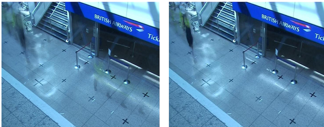
Abbildung 6.2: Links ist ein durch das Mittelwert Verfahren berechnetes initiales Hintergrundmodell zu sehen. Rechts eines, das durch das Median Verfahren bezüglich der selben Trainingssequenz berechnet wurde. Kurzzeitige Verdeckungen bereiten dem Median Verfahren weniger Probleme.
