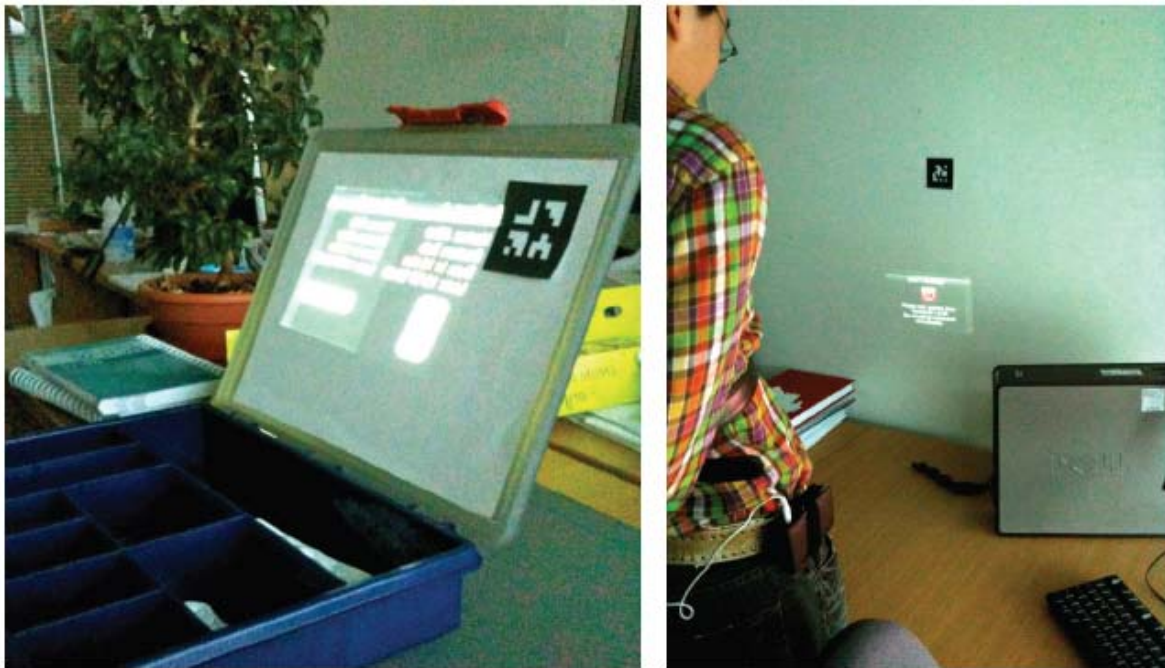
Abbildung 3.2: Links: Anleitungsschnittstelle, projiziert auf das Medikamentenfach. Rechts: Gürtelmontierter mobiler Projektor mit Wand-projektierter Schnittstelle
