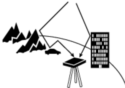
Abbildung 7 : Entstehung des Multipath-Fehlers 3
