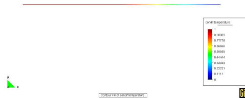
Abbildung 2.2: Visualisierung der Ergebnisse mit GiD: die Färbung zeigt, dass im Intervall [0,1] die Temperatur 1.0 Grad beträgt. Im Intervall [1,2] fällt sie ab auf 0.0 Grad.
