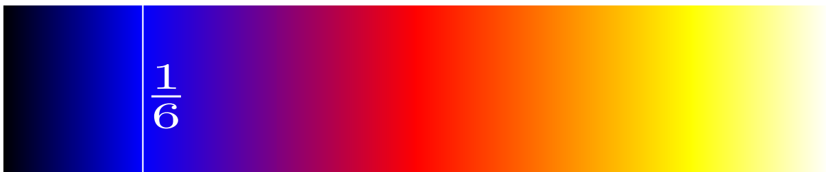
Abbildung 6.1: Farbskala zur Farbcodierung der Dichtewerte. (Standard Temperaturskala) Die Farbe Blau hat in einer entsprechenden 1D Textur die Texturkoordinate s = \frac{1}{6} .
